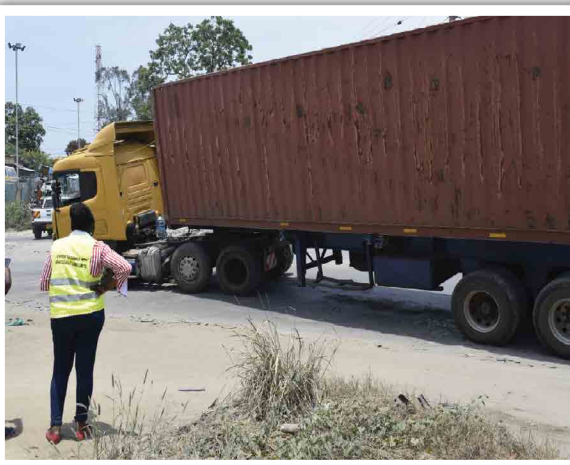
Figure 3: Rayon de braquage insuffisant pour les camions poids lourds à la jonction de Makande
